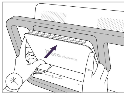
15. Fest det magnetiske bakdekselet.
